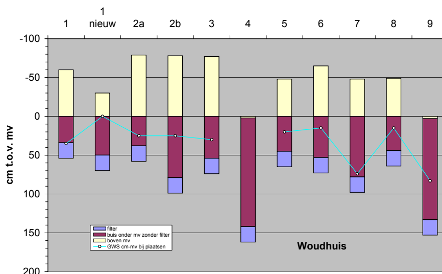
Fig. 2.10.2. De geplaatste peil- buizen in Woud- huis ten opzichte van maaiveld.
