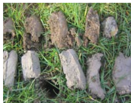
Fig. 3.1. Materiaal uit boringen. Boven met moeraskalk op 30-50 cm-mv en onder met moeraskalk verwerkt in de bovengrond.
