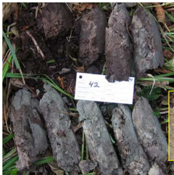
Fig. 2.3c. Materiaal uit de boring van peilbuis 41-43. Elke kluit is 10 cm. Het betreft een broekeerd met de Ah-horizont tot 25 cm, van 90-100 cm sterk lemig matig fijn zand. Ook hier op grotere diepte sterke roestverschijnselen (zie paragraaf 4.4).
