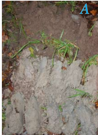
Fig. 2.3b. Materiaal uit de boring van peilbuis 51-53. Elke kluit is 10 cm. Het betreft een beekeerd met de Ah-horizont tot 15 cm, van 60-90 cm zeer sterk lemig matig fijn zand. Op grotere diepte zijn de roestverschijnselen sterker (zie paragraaf 4.4).
