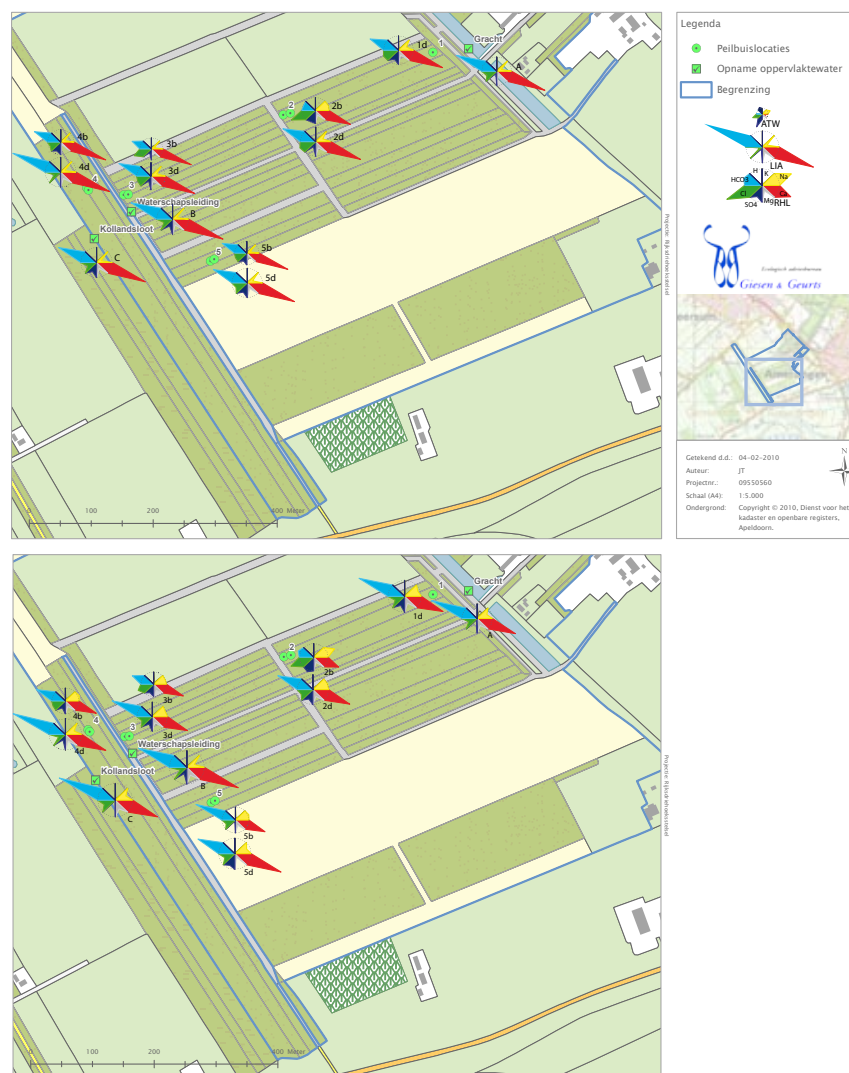
Fig. 2.3.1. De ligging van de geplaatste peilbui- zen, oppervlaktewa- ter locatie en peil- schaal in Zuylestein met Maucha diagrammen.
